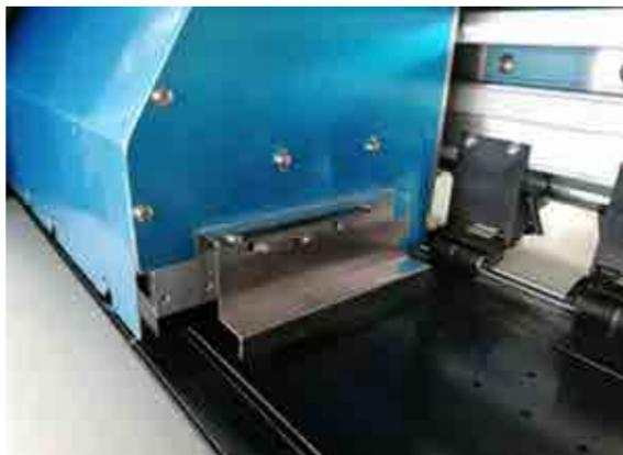
**Sensor anti colisión:** Protege y previene eficazmente daños en los cabezales durante la impresión.
