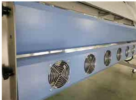
**Sistema de secado inteligente por infrarrojos:** Secado por infrarrojos con inyección de aire a través de ventiladores (coolers).
